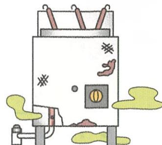
ガス機器が腐食劣化して穴が空いていると、その部分からガスが漏えいします。漏えいしたガスに近くの火が引火して爆発します。
